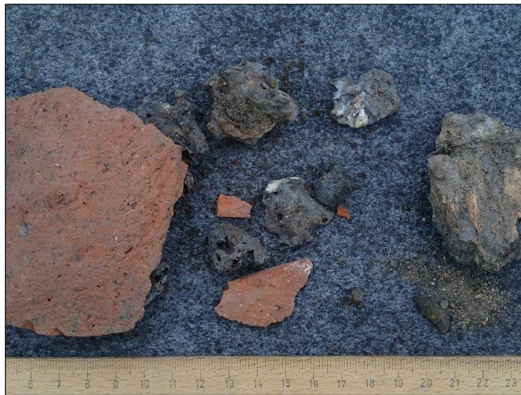
Koekuopan 15 löytöjä. Tiiltä ja kuonaantunutta tiiltä.
